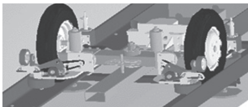
Figure 3 : vue du système de guidage sur le rail
