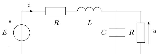
Pour simplifier les calculs, on suppose que  $RC = L/R = \tau$ . Le dipôle est alimenté par un générateur idéal de tension de force électromotrice  $E$ . Enfin, on admet que la tension  $u$  aux bornes du condensateur réel vérifie l'équation différentielle du second ordre à coefficients constants suivante
