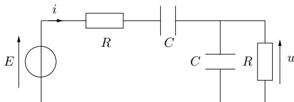
L'ensemble est alimenté par un générateur idéal de tension de force électromotrice  $E$ . L'équation différentielle vérifiée par la tension  $u$  aux bornes du dipôle  $RC$  parallèle est alors
