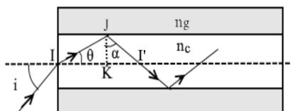
La valeur maximale de l'angle  $i$  pour que la lumière puisse être guidée dans la fibre sans perte est donnée par la relation suivante ;
