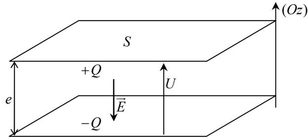
Lorsque le condensateur est chargé, ses armatures portent des charges égales en valeur absolue et de signe opposé  $-Q$  et  $+Q$ , réparties uniformément sur les armatures avec des densités surfaciques  $\pm\sigma = \pm\frac{Q}{S}$ . Dans le cas où la distance entre les armatures est très inférieure à leurs dimensions, on peut modéliser le condensateur chargé par deux plans infinis uniformément chargés. Le champ électrostatique entre les armatures a pour expression :
