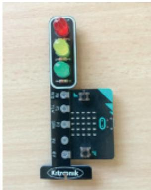
Elle comporte 3 DEL (rouge, jaune, et vert), ainsi que 5 trous de connexion qui vous permettront de fixer et de relier électriquement la carte BBC micro:bit avec la maquette à l'aide des vis et écrous fournis.
