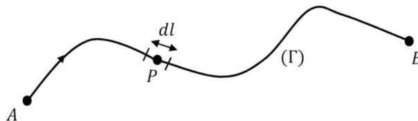
Pour un milieu homogène, c'est-à-dire  $n$  indépendant de la position du point  $P$ , et un trajet  $\Gamma$  confondu avec le segment  $AB$ , on obtient de façon directe
