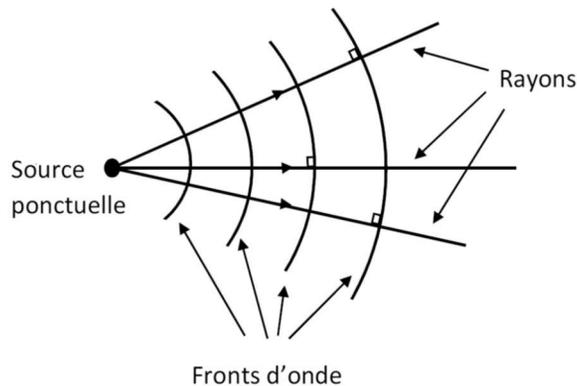
Dans un contexte général, les rayons sont définis comme les normales aux fronts d'onde, c'est-à-dire les « chemins » suivis par l'onde. Contrairement à la description de l'onde avec une fonction d'onde  $S(M, t)$ , la description de la propagation par un faisceau de rayons ne prend pas en compte l'amplitude, la phase et la polarisation de l'onde.
