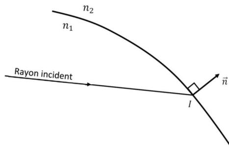
**Première loi de Descartes** : le rayon réfléchi et le rayon transmis (réfracté) sont dans le plan d'incidence.
