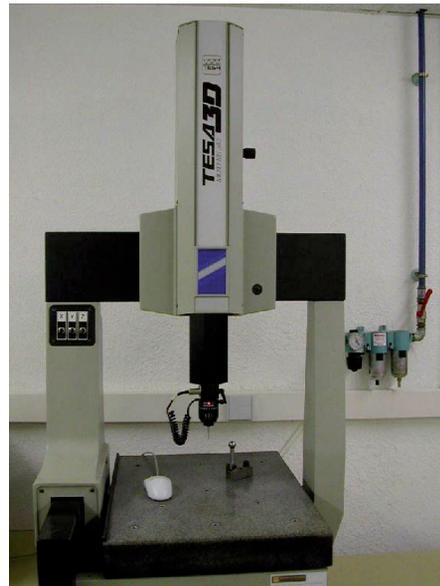
FIGURE 1.7 – Machine à mesurer
