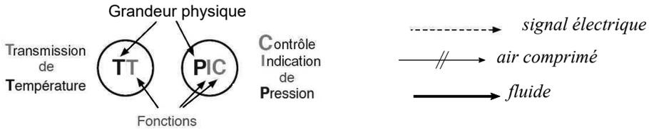
FIGURE I.8 – Eléments de représentation en norme TI
