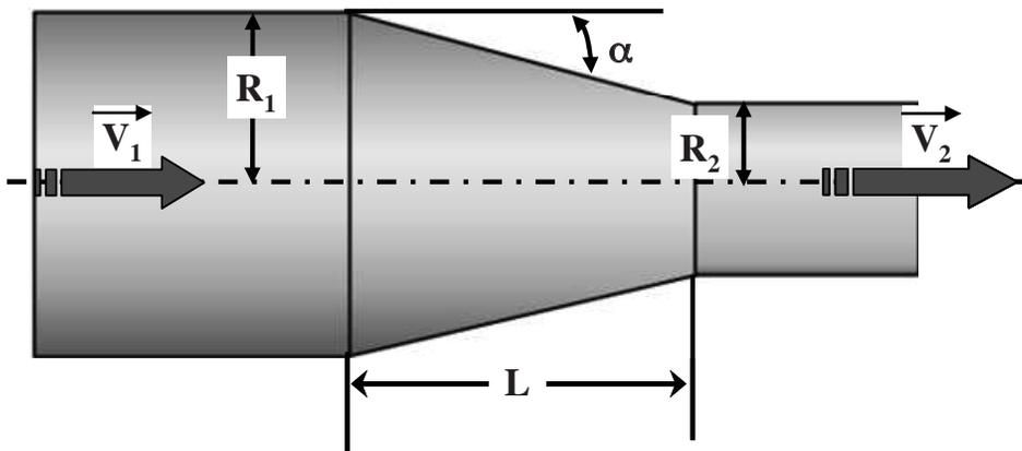
Figure II.4 - Schéma du convergent en canalisation à section circulaire
