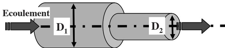
Figure II.1 - Schéma du rétrécissement de canalisation
