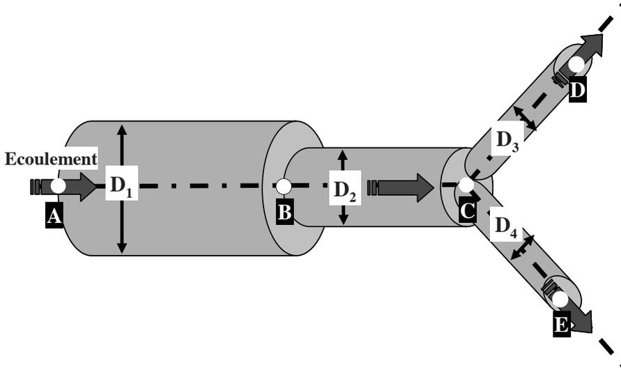
Figure II.2- Schéma du réseau ramifié
