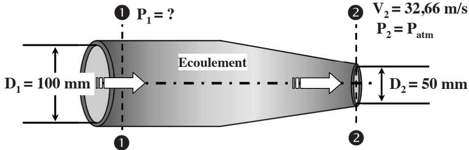
Figure II.5 - Schéma de la buse d'arrosage
