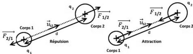
À l'aide des schémas ci-dessus, donner l'expression vectorielle de la force électrostatique s'exerçant entre deux corps ponctuels 1 et 2, de charges  $q_1$  et  $q_2$ , séparés par une distance  $d$ .
