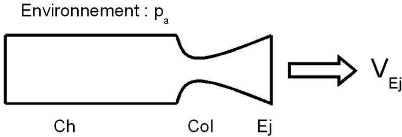
**Figure I.2- Points caractéristiques d'une tuyère**
