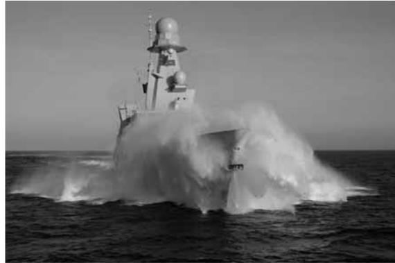
**FIG. I.4 :** *Impact hydrodynamique : exemple sur une frégate (Photo : DCNS)*
