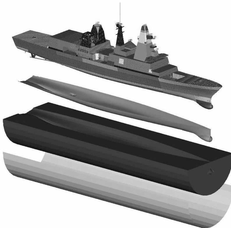
**FIG. I.9 :** *Simulation couplée en fluide stagnant : analyse fréquentielle des vibrations d'un bâtiment de surface avec interaction fluide/structure par couplage d'éléments finis fluide/structure et d'éléments infinis fluide (Calcul : DCNS Lorient)*
