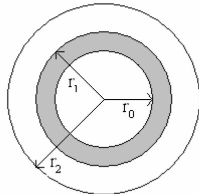
1°) Calculer  $R_{ta}$  pour un tube de diamètre extérieur 48,3 mm et d'épaisseur 2,6 mm sachant que :  $h_i = 2754 \text{ W/m}^2\text{K}$   $h_e = 12,52 \text{ W/m}^2\text{K}$   $\lambda_a = 52 \text{ W/mK}$ .
