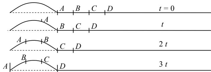
► **5.** Dans le référentiel du laboratoire,  $A$  décrit un segment vertical d'abord vers le haut puis vers le bas. Dans le référentiel en mouvement, un point fixe de la corde se déplace vers la gauche à la vitesse  $-\vec{V}$ . Le point  $A$  décrit dans ce référentiel un mouvement résultant de la composition de ces 2 mouvements, il décrit donc un arc de courbe vers la gauche.
