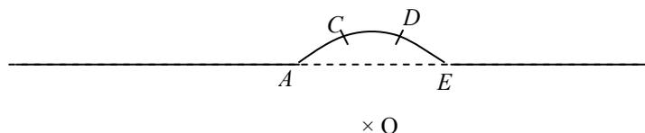
Pour étudier la célérité  $V$  de cet ébranlement le long de la corde, on se place dans un référentiel animé d'un mouvement de translation de vitesse  $V$  parallèle à la corde. Une petite portion de corde  $CD$  située entre  $A$  et  $B$  semble alors tourner le long de l'arc de corde à la vitesse  $V$  (voir exercice précédent).
