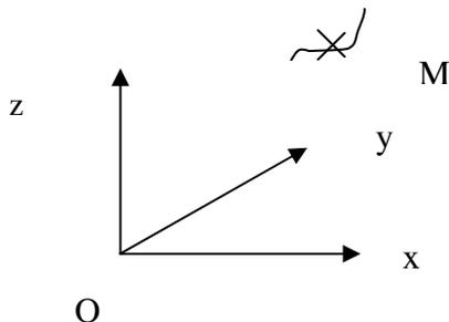
On définit donc la trajectoire parcourue par le mobile M, c'est-à-dire une courbe, et le mouvement de ce mobile sur la trajectoire. On obtient donc les équations de la **trajectoire** qui sont données par deux équations, par exemple  $y=f(x)$  et  $z = g(x)$ , les équations des projections de la courbe sur les deux plans de coordonnées  $xy$  et  $xz$ , et les **équations horaires** du mouvement, qui sont données par les trois fonctions  $x(t)$ ,  $y(t)$  et  $z(t)$ .
