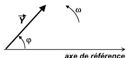
A la grandeur sinusoïdale  $y(t) = Y_{\max} \cdot \sin(\omega t + \varphi)$  on associe le vecteur de Fresnel  $\vec{Y} = [Y; \varphi]$  dans le plan de Fresnel correspondant à la pulsation  $\omega$ . La longueur de vecteur représente la valeur efficace du signal.
