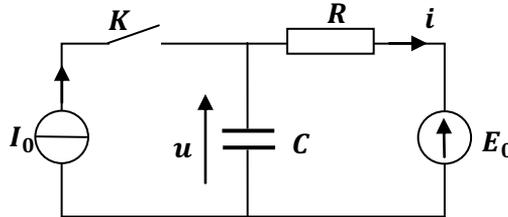
Soit le circuit ci-dessus, faisant intervenir deux générateurs. L'interrupteur  $K$  est ouvert depuis longtemps ( $t < 0$ ) et il est fermé à l'instant  $t = 0$  choisi comme origine des temps.
