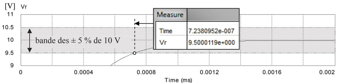
La sonde montre que le temps de réponse est de  $0,72 \mu\text{s}$  environ, soit six fois plus faible que précédemment. On se rend compte de la nécessité d'utiliser une charge adaptée à la ligne, car cela permet d'avoir un temps de réponse beaucoup plus faible que précédemment (autorisation d'un débit d'informations plus élevé). Cela évite également l'apparition de pics de surtension aux bornes de la charge, potentiellement destructeurs.
