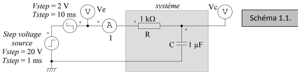
Lancer la simulation sur  $[0 ; 20\text{ ms}]$ . Sur le même graphe, tracer la tension  $V_c$  aux bornes du condensateur et la tension d'alimentation  $V_e$ . On considère que le régime
