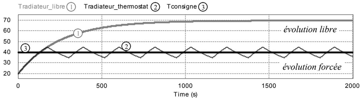
Bien qu'il existe, le temps de réponse du radiateur est impossible à établir en présence du thermostat car on n'est pas dans le cadre d'un régime linéaire du système : on ne laisse pas le radiateur évoluer librement du fait de la présence de cette régulation de type *tout-ou-rien* (0 % ou 100 % de la puissance de chauffe). Seule l'évolution libre de ce système permet de déterminer le temps de réponse à 5 %.
