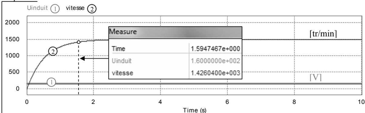
La sortie évolue de 0 à 1500 tr/min, donc varie sur  $\Delta n = 1500 - 0 = 1500$  tr/min. Le temps de réponse à 5% est la durée mise par la vitesse à rester dans la bande des  $\pm 5\%$  de  $\Delta n$ , c'est-à-dire la bande des  $\pm 75$  tr/min autour de 1500 tr/min. Ici, il s'agit donc du temps mis pour atteindre  $1500 - \Delta n = 1500 - 75 = 1425$  tr/min (= 95% de 1500 tr/min). La sonde de mesure indique la valeur  $t_r \approx 1,59$  s (voir ci-dessus).
