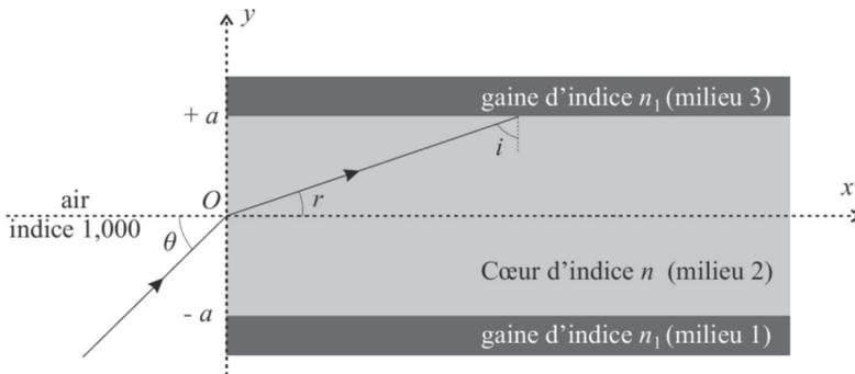
Fig. 1. Fibre optique en coupe
