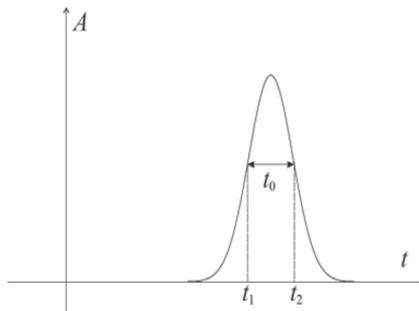
Fig. 2. Impulsion lumineuse
