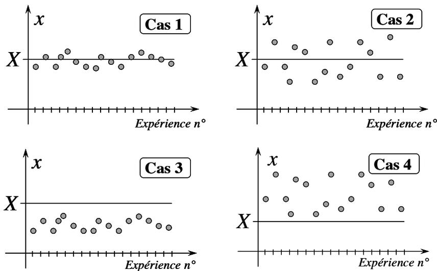
Le cas 1 présente une faible erreur aléatoire (instrument fidèle) et une faible erreur systématique (instrument juste). Dans le cas 2 l'instrument de mesure est peu fidèle mais juste, dans le cas 3 il est fidèle mais peu juste et dans le cas 4 il est peu fidèle et peu juste.
