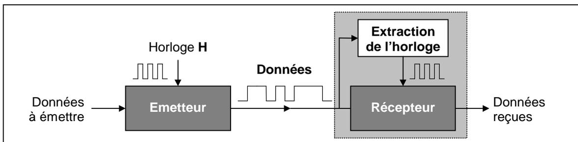
Les transitions du signal de données doivent être suffisamment nombreuses pour éviter la perte de la synchronisation. Cette deuxième alternative est extrêmement utilisée car elle permet de réaliser des transmissions à **très haut débit**.
