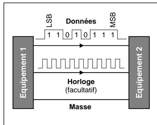
Les liaisons effectuées par l'intermédiaire d'ondes infrarouges ou lumineuses, d'ondes radio, de fibre optique, etc. sont de type **série** car le support ne peut transmettre qu'une information à la fois.
