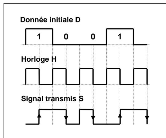
Ce système permet de faire apparaître sur la donnée envoyée des fronts montants ↑ ou descendants ↓ pour toutes les périodes d'horloge. Du côté réception, il est alors facile d'élaborer une horloge de réception en se **synchronisant sur la détection des fronts**.
