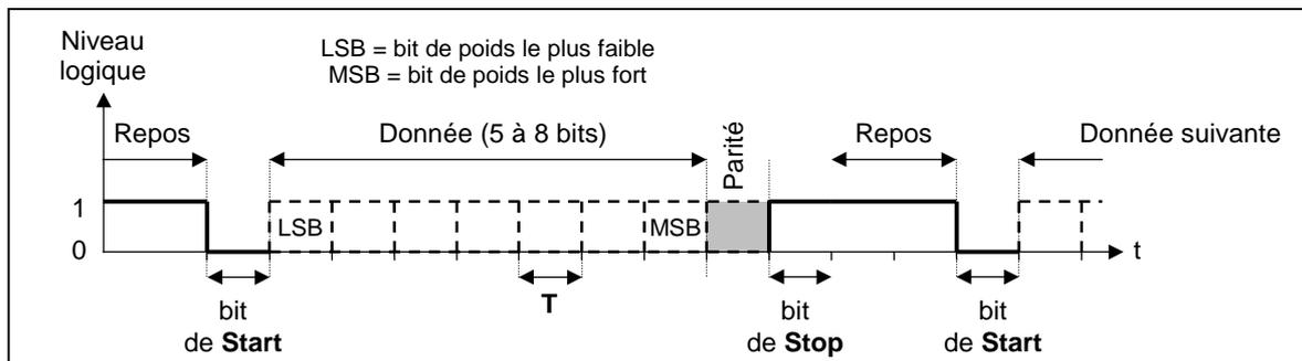
Un **bit de parité** facultatif permet le contrôle de la transmission. Entre deux données successives, la ligne peut être inactive pendant une durée variable (Repos).
