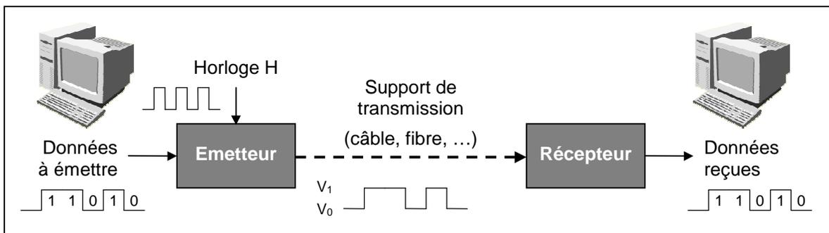
Le problème consiste à retrouver à l'autre extrémité de la chaîne de **transmission numérique** les mêmes données qu'à la source. Ces données sont transmises suivant un rythme régulier, fixé par un signal de référence appelé l'**horloge H**.
