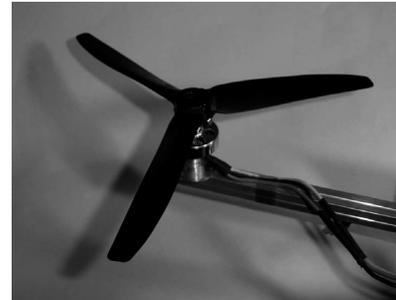
$\tau$ ,  $k_v$  et  $k_Q$  sont des constantes caractéristiques de l'ensemble { moteur + hélice }. Le terme  $-k_Q\omega^2$  provient du couple de frottement aérodynamique de l'air sur l'hélice tournant à grande vitesse.
