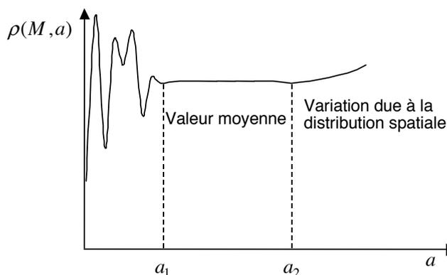
**Fig. I-1** Schéma de définition de la masse volumique
