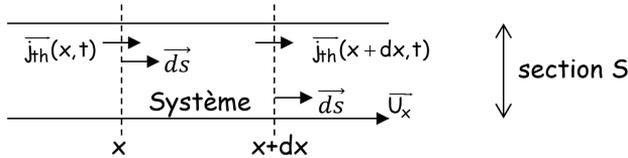
Le conducteur thermique (ici le fil constituant le fusible) est supposé unidimensionnel, ce qui signifie que la température ne dépend que d'une variable d'espace et du temps :  $T(\underline{x}, t)$ . Par la loi de Fourier, l'unidimensionnalité de  $T$  impose l'unidirectionnalité de  $\vec{j}_{th}$  :
