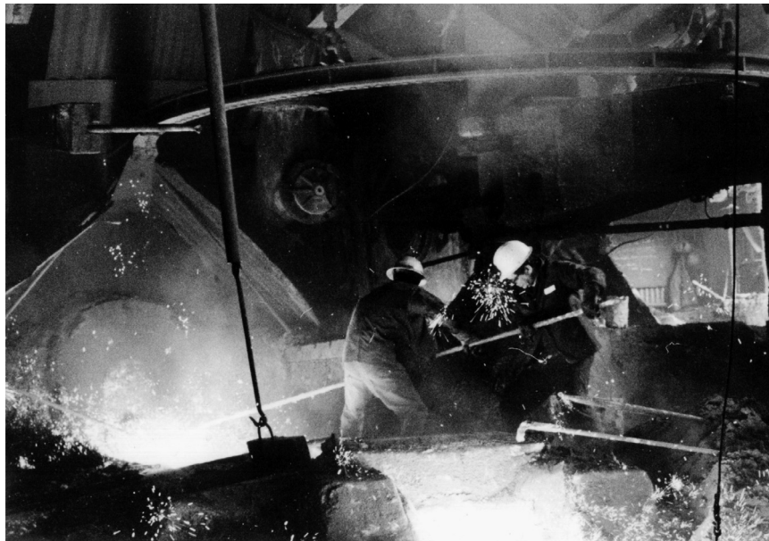
“Ouvrier manœuvrant le bouchon d’argile d’un haut fourneau à l’usine sidérurgique La Providence à Réhon en 1978”, Bruno Barbaresi 1
