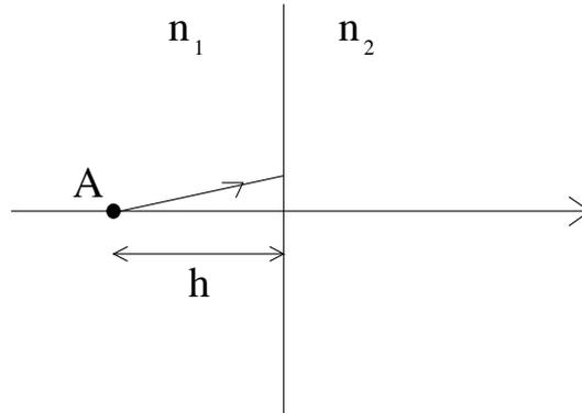
La construction du rayon émergent dans le milieu  $n_2$  est la suivante :
