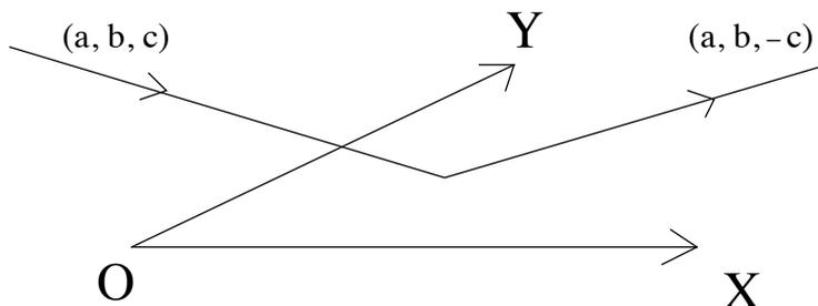
Si l'on veut que le rayon reparte dans une direction opposée à celle incidente, il faut renverser le vecteur de propagation en  $(-a, -b, -c)$ .
