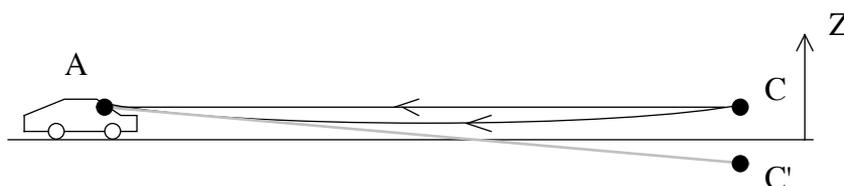
Ceci s'explique par le fait que la température du goudron est très élevée et que l'air situé au niveau de la route est plus chaud que l'air situé quelques centimètres au dessus. Il en
