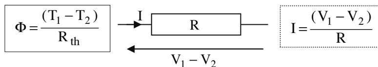
L'analogie électrique nous permet aussi de dégager la notion de *conductance thermique* (ou coefficient de transmission)  $K$ .
