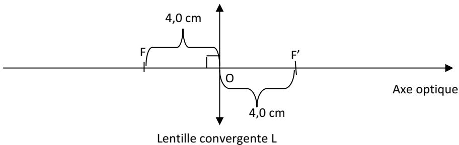
$\overline{OF}$  représente la grandeur algébrique de la distance  $OF$ , ici  $\overline{OF} = -4,0 \text{ cm}$ .
