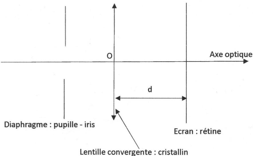
La distance  $d$  entre le cristallin et la rétine est fixe et voisine de 15 mm.
