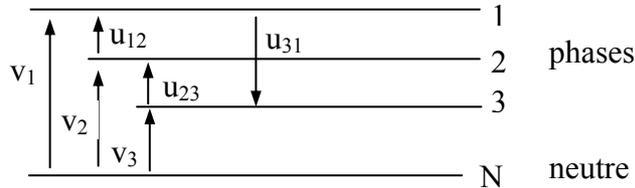
Le système est composé de trois phases et d'un neutre.
