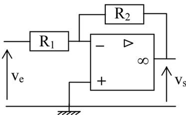
En appliquant le théorème de superposition, on calcule le potentiel de l'entrée inverseuse notée  $V^-$  :
