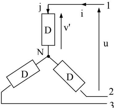
En étoile, chaque dipôle est soumis à la tension simple  $v$  égale à  $v'$  et est traversé par le courant par phase  $j$  égal au courant en ligne  $i$ .
