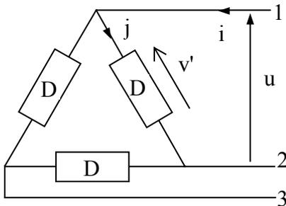
En triangle, chaque dipôle est soumis à la tension composée  $u$  et est traversé par le courant par phase  $j$ .
