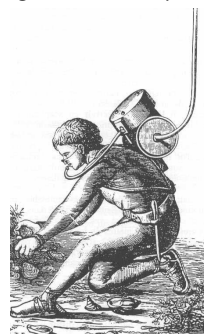
Scaphandrier pourvu du régulateur de Denayrouze, ayant ôté le masque.
