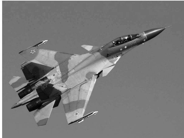
FIGURE 1.2 – Le Sukhoï Su-30 MKI est un avion en configuration “triplan” et dispose également d’une capacité de poussée vectorielle, c’est-à-dire qu’il peut orienter le jet de ses réacteurs de manière à produire un moment sur les trois axes de l’avion.
