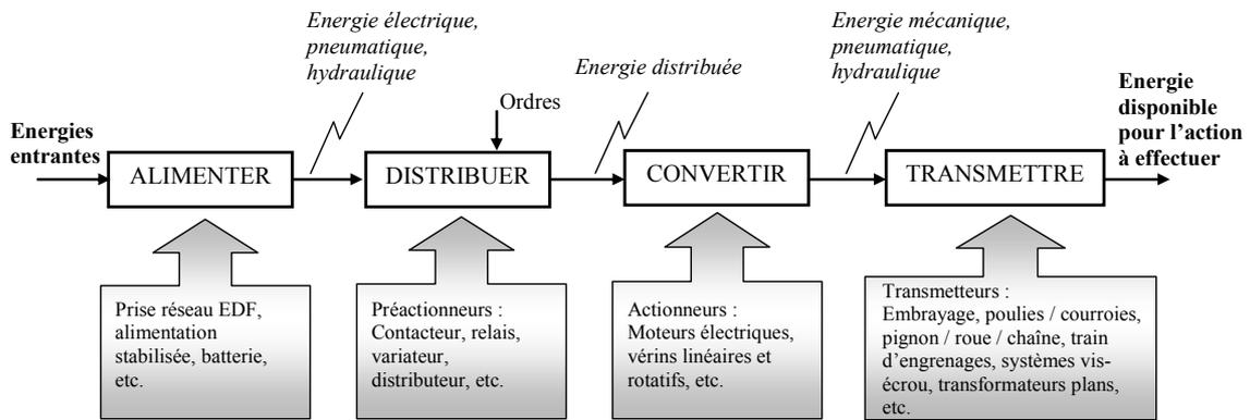
Pour des raisons de sécurité, l'énergie issue de la chaîne d'information est faible, et n'est pas suffisante pour être utilisable directement par les actionneurs.
