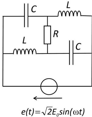
On pose  $x = LC\omega^2$ . Déterminer le courant  $i(t)$  traversant le conducteur ohmique de résistance  $R$ , en prenant  $x = 1$ .
