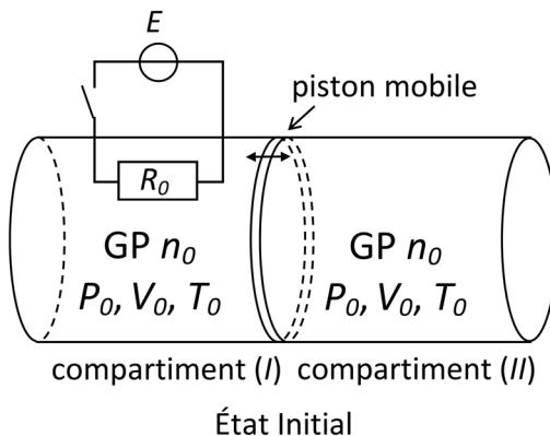
Un conducteur ohmique de résistance  $R_0$ , de capacité thermique négligeable et parcouru par un courant d'intensité  $I$  pendant une durée  $\Delta t$  permet de chauffer lentement le gaz du compartiment (*I*). Un thermomètre, placé dans le compartiment (*II*) permet d'y mesurer la température du gaz : à l'état final,  $T_2 > T_0$ .
